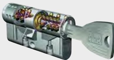
Le **cylindre à billes** est doté d'un système de sécurité à balayage et perçage breveté tridimensionnel ainsi que d'un système anti-arrachement. La forme spéciale de la clé permet un verrouillage facile et empêche la flexion et la rupture de la clé. La clé réversible symétrique peut être insérée très facilement dans le cylindre.
