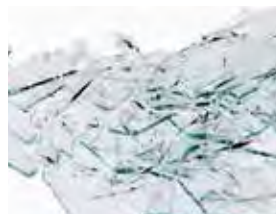
Vitrage classique : en cas de choc, se brise et risque de blesser les personnes.
