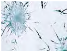
Vitrage feuilleté : en cas de choc, ne se brise pas, le vitrage reste entier bien que fissuré (ex : le pare-brise de votre voiture)
