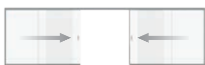
Système coulissant à la française – ouverture des deux côtés, fermeture au milieu.
