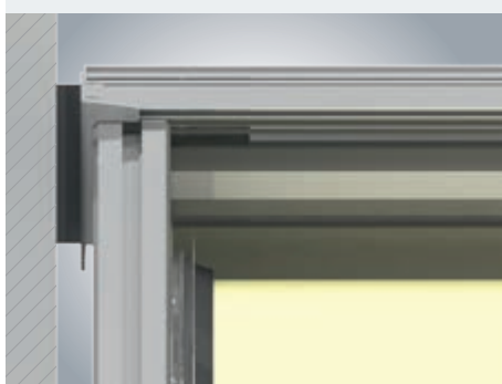
Fixation du PergoTex II Basic dans une niche ou latérale, à un mur.
