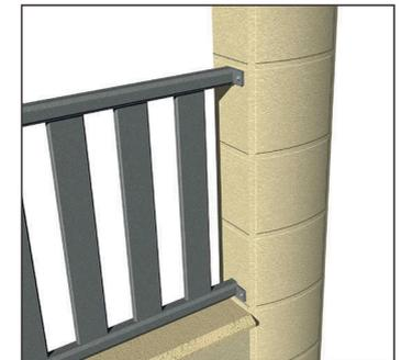
Fixation clôture avec platine
