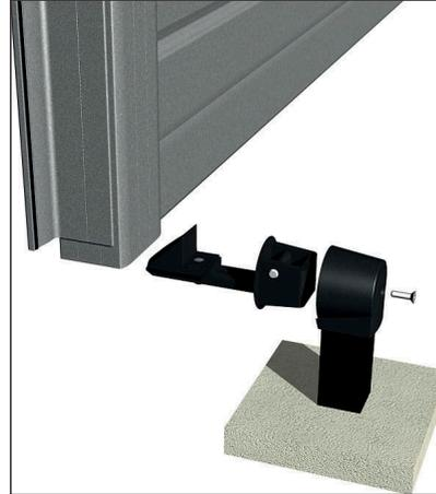
Détail de pose et réglage possible de l'arrêt d'ouverture
