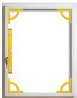
Le cadre du vantail soudé est mis d'équerre.
